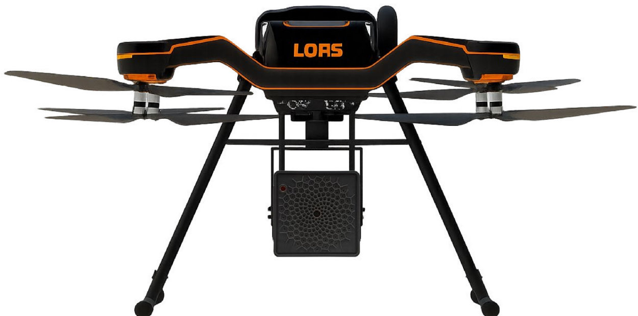
Drohne LOAS Tfos mit dem SoundCam Ultra 3 Sensor
