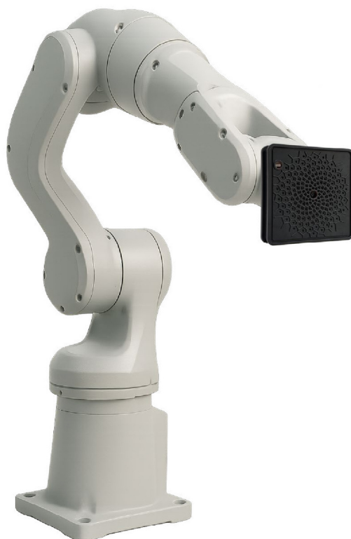
6-Achs-Industrieroboterarm mit dem SoundCam Ultra 3 Sensor
